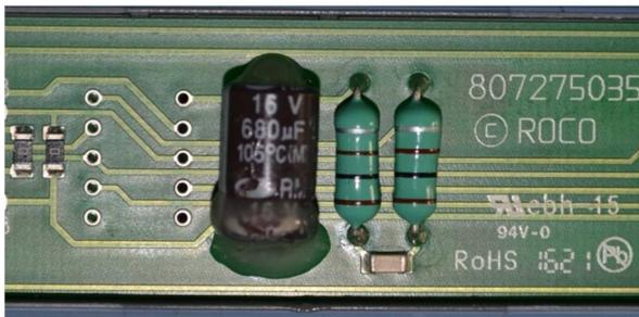
Alu-ELKO 1000 UF / 16V LOW ESR, (im Bild ein ZIMO Alu-ELKO 680 µF / 16V von einem MX645 an Drähten), in die Bezeichneten + / - Pol-Lötlagen einsetzen und löten. Anschliessend mit einem 2K-Klebstoff sichern.
