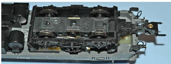
MK1 In den Normschacht einrasten, Litzen beidseitig mit einem Sekundenklebstoff fixieren (Pfeil **rot**) und durch die Schlitze im Lokrahmen nach oben durchziehen.
