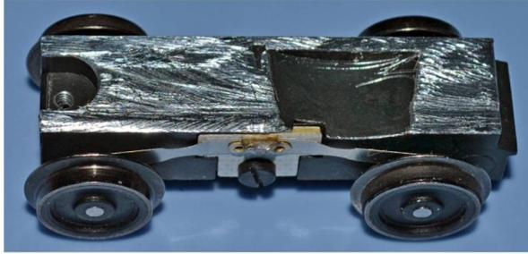
Ansatz- 00730009 und Linsenschraube 0073005 ausdrehen und den Drehgestellrahmen entfernen.
