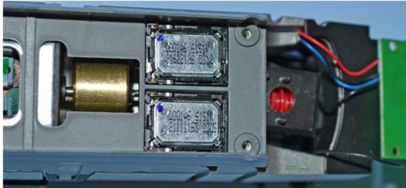
Auf einer Seite die Litzenverbindungen ablöten und die 4 GF-Schrauben M1,6x5 ausdrehen. Die Folie von den Lautsprechern 68400400 abziehen und in die Inneneinrichtung 15424001 lagerichtig (Kontaktfedern-Richtung links zum Motor) einkleben. Alles wieder montieren, löten.
