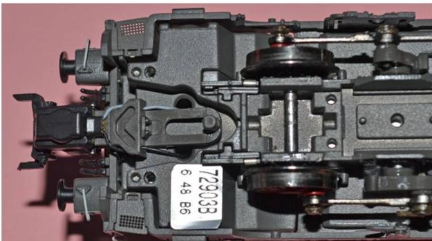
Eine Telex-Kupplung E117993 in die Kupplungskammer der Kupplungsdecksel TS #137422 bis zur Einrastung einschieben.
