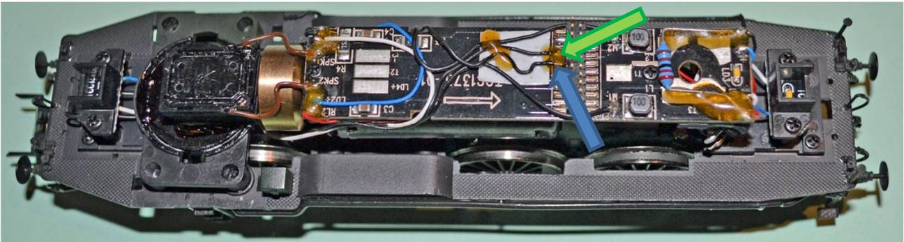
MX644D Sounddecoder lagerichtig in die Schnittstelle einsetzen (Buchse nach oben).
