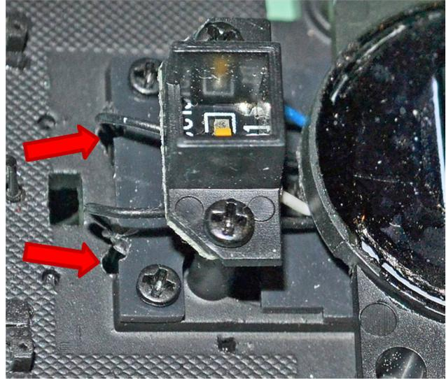
Litzen durch die Bohrungen nach oben zur Platinen-Schnittstelle durchziehen, dabei genügend grosse Schlaufen bilden um den Schwenkbereich der Kupplungsdecksel nicht einzuschränken.
