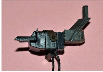
Pflug 141909 (TS-DG-Blende+Pflug) und Normschacht von der Kupplungsdeichsel 141912 (beide im TS-Kupplungs+Steckteile) abziehen. Mit einer runden Nadelfeile beidseitig eine Rille feilen.
