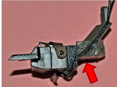
Litzen mit einem Sekundenklebstoff, wie in den Bildern sichtbar, einkleben.
