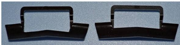
Für die Digitalkupplung muss der Schienenräumer wie im Bild links nachgearbeitet (ca. auf die Hälfte dünner) werden.
