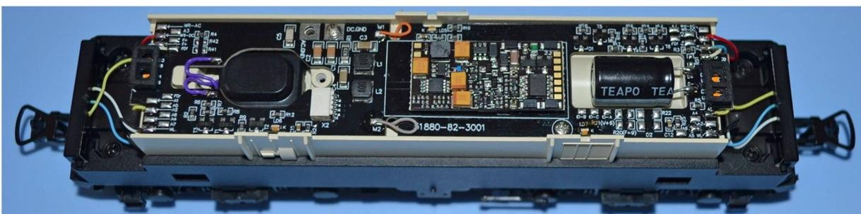
ELKO-Füsse an die mit + und - bezeichneten Löt pads der Platine löten.
