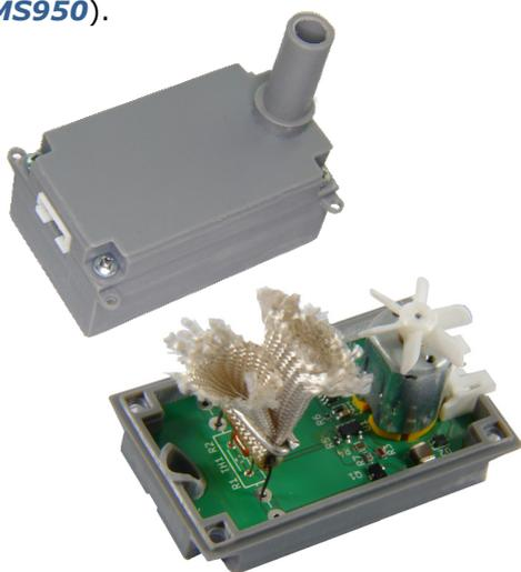
Prototyp des Raucherzeugers mit Abmessungen von 49 x 29 x 23 mm (Abm. ohne aufgeschraubter Schlotverlängerung)
