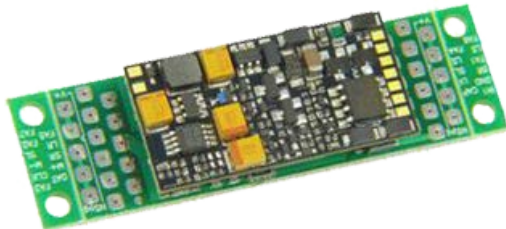
ADAPLU mit Sound-Decoder MX645P22 , 45 x 15 x 8 mm
