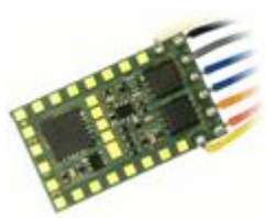
MX820Y Unterseite (mit Löt-Pads für 16 Signallämpchen oder -LEDs)
