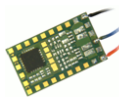
MX820Y Unterseite (mit Löt-Pads für 16 Signallämpchen oder -LEDs)
