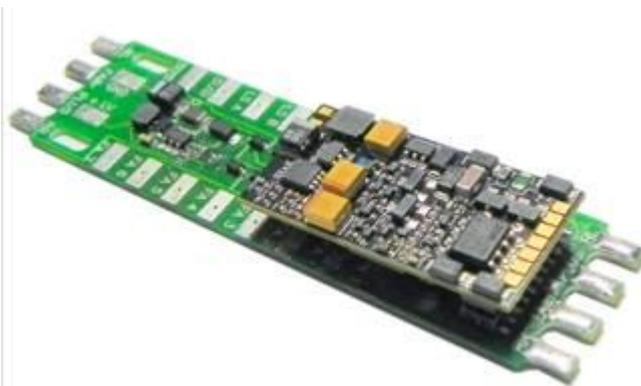
Im Bild: ADAPUS15 mit 1,5 V Niederspannung, 71 x 18 x 4 mm) ADAPUS15 mit aufgestecktem ZIMO Sound-Decoder MX645P22
