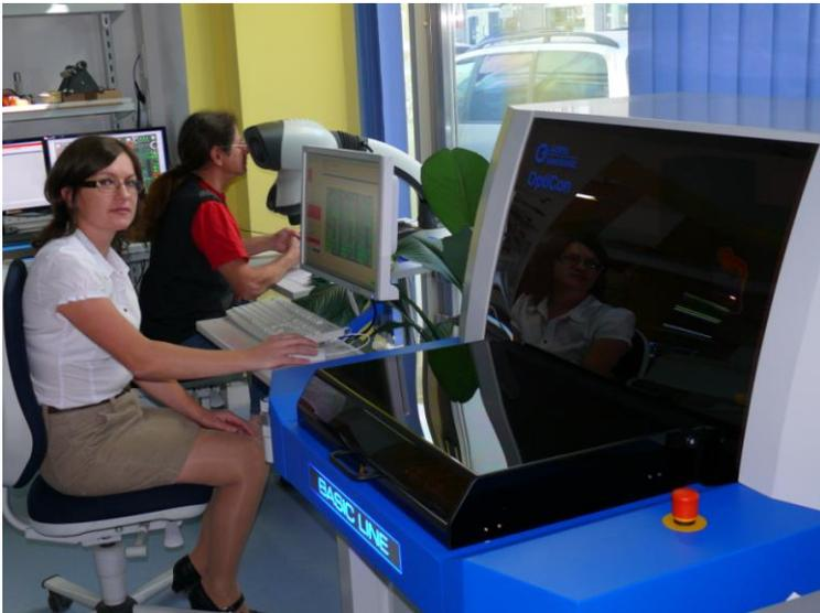
AOI-System (während der Kontrolle eines Nutzens MXULF-Platinen)
