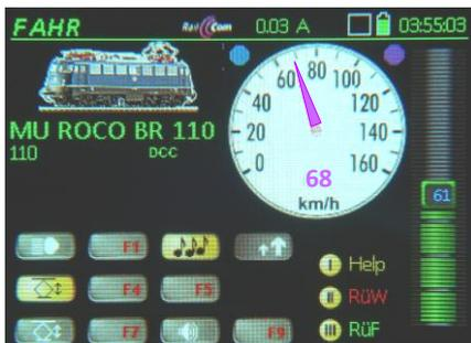
Mit Hilfe von RailCom wird am Tacho die „echte“, im Decoder gemessene und rückgemeldete Geschwindigkeit angezeigt; der Tacho Zeiger erscheint in Magenta-Farbe als Kennzeichen.
