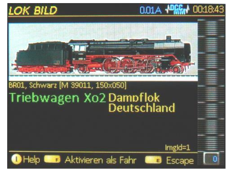
Auswahl eines Lok-Bildes aus einer nach Ländern und Fahrzeugarten gegliederten Bibliothek; auch Einspielen eigener Fotos möglich.
