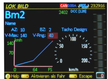
Systemeinstellungen; hier werden Vorgaben zur Darstellung des Fahrzeugs im FAHR - Zustand gemacht, wie beispielsweise das Anzeigeverhalten des Tachos: wenn keine echte Rückmeldung (RailCom) aus der Lok vorhanden ist, muss die aktuelle Geschwindigkeit aus der Fahstufe abgeleitet werden, nach einer zu definierenden Relation und in einer zu definierenden Nachlaufzeit; außerdem kann ein Tacho-Design ausgewählt werden und der Rangierbereich festgelegt.
