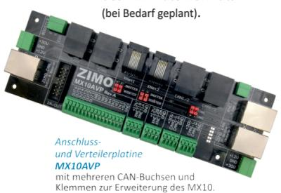
Anschluss- und Verteilerplatte MX10AVP mit mehreren CAN-Büchsen und Klemmen zur Erweiterung des MX10.
