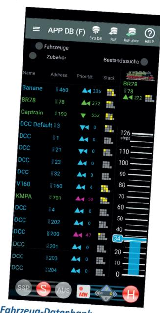
Fahrzeug-Datenbank Liste der in der App direkt aufrufbaren Adressen (Fahrzeuge) - eine Teilmenge aus der Systemzentrale - mit Info über Richtung, Fahrstufe oder Geschwindigkeit, Zustand der Funktionen.
