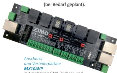
Anschluss- und Verteilerplatine MX10AVP mit mehreren CAN-Buchsen und Klemmen zur Erweiterung des MX10.
