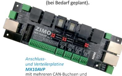
Anschluss- und Verteilerplatine MX10AVP mit mehreren CAN-Büchsen und Klemmen zur Erweiterung des MX10.
