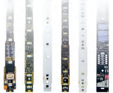
Die wichtigste spezielle ZIMO Eigenschaft ist die ZWEITADRESSE, die aus den schaltungs- und softwaremäßig zugrundeliegenden Funktions-Decodern übernommen wurde. Sie wird typischerweise auf die Adresse des Triebfahrzeugs gesetzt, wodurch die Innenbeleuchtung aller Wagen des Zuges, sowie die Außenlichter des Schuss- oder Steuerwagens über die Funktionen (Funktionstasten) einer einzigen Adresse geschaltet werden können.
