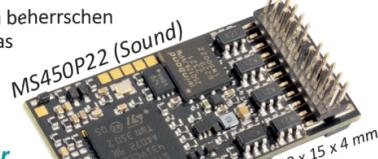
PluX22-Schnittstelle, diese Version ist der Bestseller unter den Sound-Decodern; Abmessung gleich auch mit Z1MTC.
