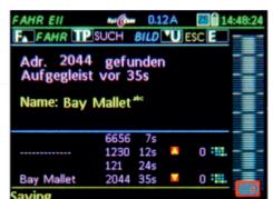
Die „Aufgleissuche“ wird verwendet, um die unbekannt Adresse(n) eines oder weniger Fahrzeuge zu finden. Das aktuell gesuchte Fahrzeug wird kurzzeitig stromlos gemacht:
