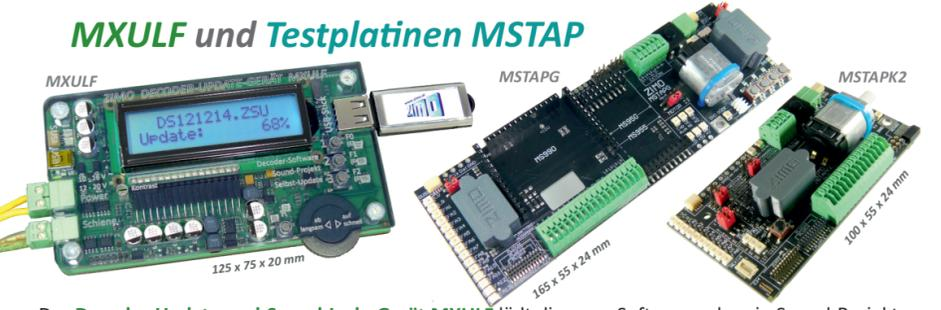
Das **Decoder-Update-und-Sound-Lade-Gerät MXULF** lädt die neue Software oder ein Sound-Projekt wahlweise vom USB-Stick oder vom Computer über die SUSI-Schnittstelle, welche sehr schnelles Laden von Sound-Projekten in den Decoder ermöglicht: ca. 5 min statt 1 Stunde. Auf den Test- und Anschlussplatinen MSTAPK (für „kleine“ Spuren) und MSTAPG (für ZIMO Großbahn-Decoder) gibt es für alle ZIMO Decoder-Typen mit Schnittstellen einen direkten Steckplatz.
