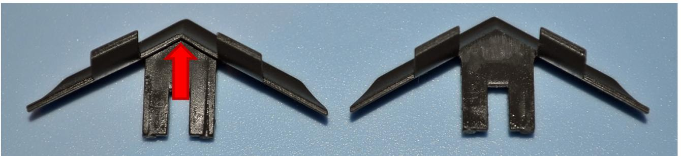
Den Steg (Pfeil **rot**) am Schienenräumer bis zur Anschraubfläche flachfeilen und den Schienenräumer wieder montieren.
