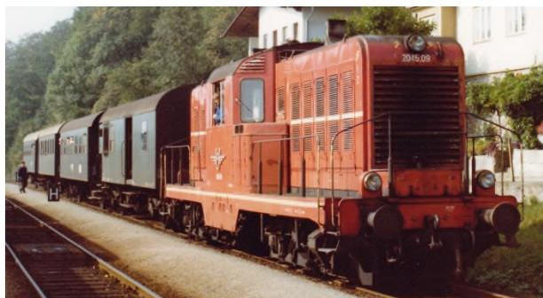
Die erste dieselelektrische 1000-PS-Lokomotive der Reihe 2045 brauchte fünf Jahre von der Bestellung bis zur Lieferung, weil hier nicht eine hydraulische, sondern eine elektrische Kraftübertragung vorgeschrieben war, deren Lieferung sich lange hinzog. Diese Bauart mit einer Achslast von 18t, war zunächst, für Nebenbahnen zu schwer. Mit Mittelführerstand und zwei symmetrischen Anlagen zu je 500 PS ist die 2045 den amerikanischen Kriegsdieselloks nach-
