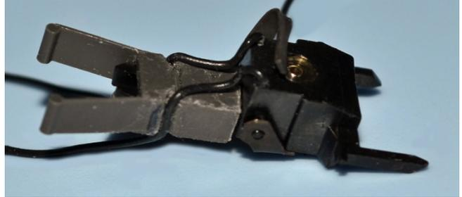
Krois MK1 Universalkupplung in die Kupplungskammer einsetzen, Schlaufen bilden und die Litzen mit einem Schnellkleber in den Schlitz befestigen.
