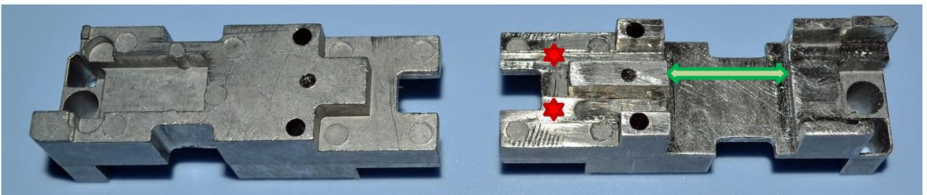
Für den Lautsprecher eine Freistellung 18 mm breit ( $\leftrightarrow$ ) und 6.5mm tief ausfräsen. Für die Verlegung der Litzen 2 Nuten 3x3mm (★)ausfräsen. Anschliessend sorgfältig entgraten.
