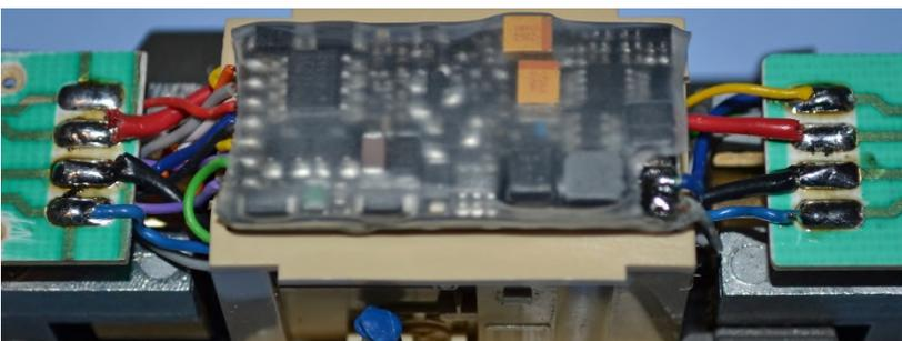
MX645 Sounddecoder mittig positionieren und mit einem Tropfen Schnellkleber befestigen.
