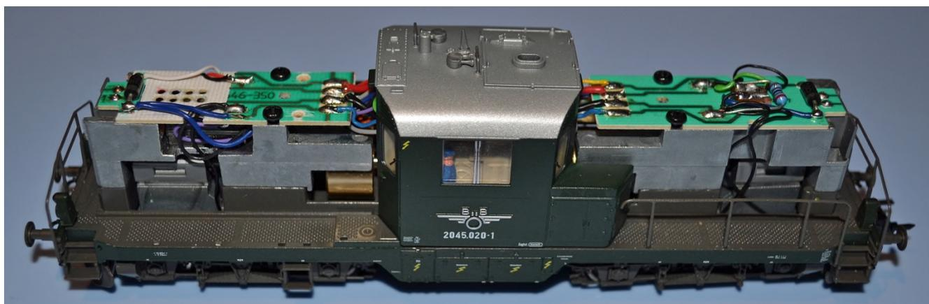
Führerhaus und beide Vorbauten einsetzen und mit den 2 GF-Schrauben M2x6 befestigen.
