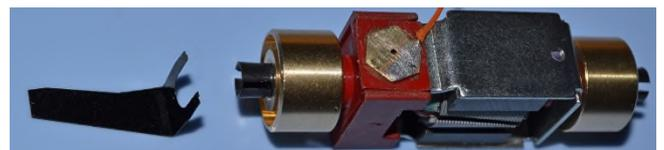
Kohlenbürste ausdrehen, Feder für Kohlenbürste #86207 entfernen, einen Schlitz in die Oberfläche sägen, eine orange Litze in den Schlitz löten und die Lötstelle planfeilen. Kohlenbürste wieder ein-
