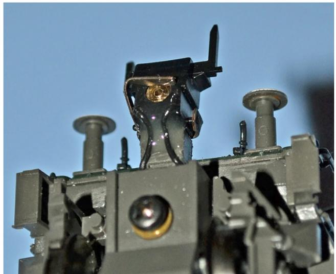
Die beiden GF-Schrauben M2x5 lösen, Getriebeboden abheben, Kupplungskammer mit der MK1 Universalkupplung einsetzen und den Getriebeboden mit den zwei GF-Schrauben wieder befestigen. Die kritischen Stellen mit einem 2K-Klebstoff sichern.
