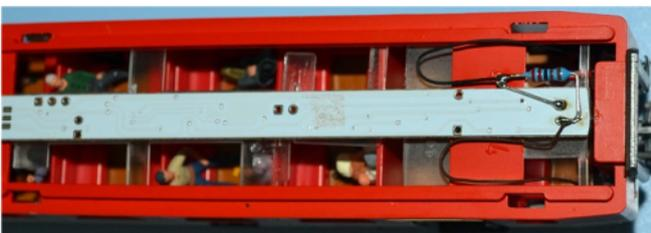
**Abhilfe:** Beim Decodereingang der Lichtleiste einen 2k2 Widerstand einlöten und an diesem die Litzen anlöten. Muss bei jeder Lichtleiste mit Decoder gemacht werden, also bei jedem Wagen.
