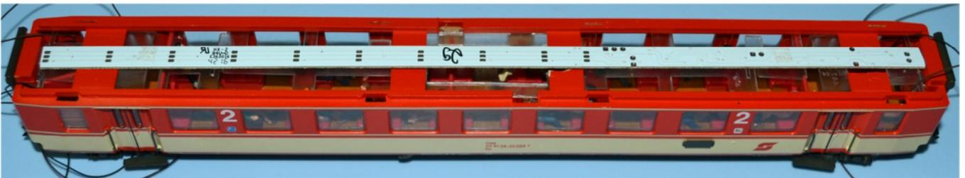
Gehäuse aufsetzen und die Litzen durchziehen. Lichtleiste auflegen, kontrollieren ob alles passt.
