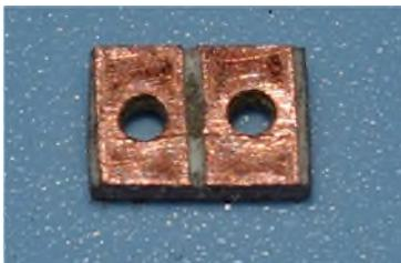
Aus einer Streifenplatine zwei kleine Stücke zu-schneiden. Je eine Diode auf diese Stücke mit einem Sekundenkleber fixieren und verlöten.
