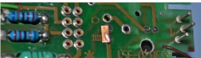
Auf beiden Seiten der Platine in die Pads Ø 1,0 mm Löcher bohren, 1 mm Steckstifte einsetzen und mit den Pads verlöten. Oberstehende Zapfen abzwicken und Flächen planfeilen.
