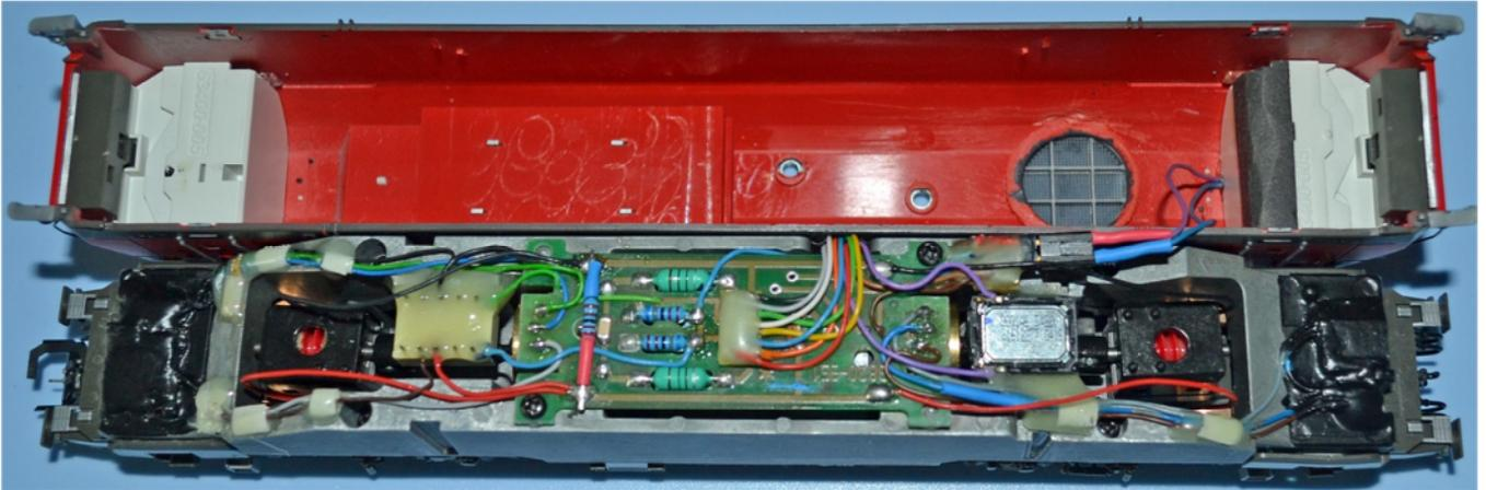
Buchse der Führerstandsbeleuchtung auf den Stecker schieben (roter Schrumpfschlauch zur roten Markierung) und das Gehäuse aufsetzen, einrasten - fertig.
