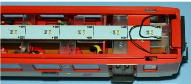
Lichtleiste umdrehen und die Litzen kreuzweise anlöten damit beim Montieren der Kupplungsanschluss rechte Schiene rechts ist und der Kupplungsanschluss linke Schiene links ist.
