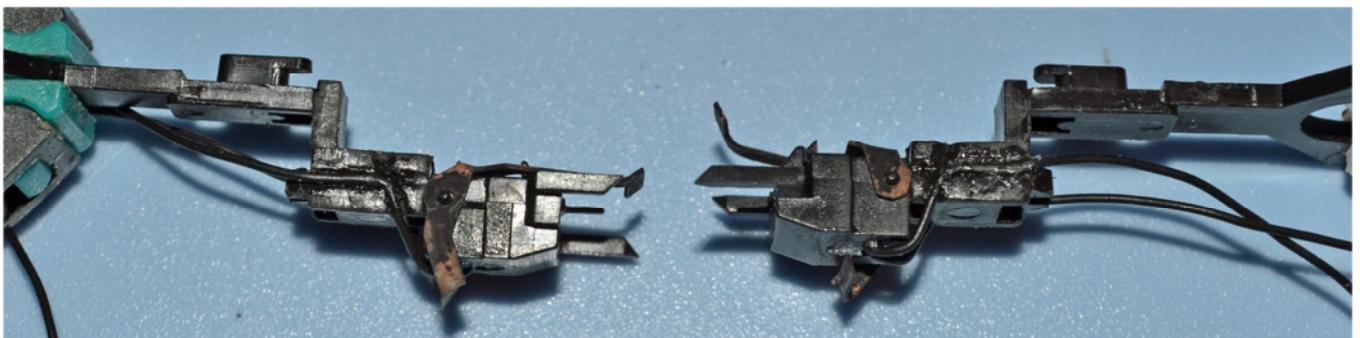
Kreis stromleitende Kupplung in den Normsacht einrasten und die Litzen mit einem Sekundenkleber in den Rillen befestigen. Wichtig: die Litzen seitlich gut andrücken.
