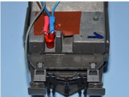
LED's rot in die linke Aussparung einsetzen, Füße abwinkeln, kürzen und die Litzen anlöten.
