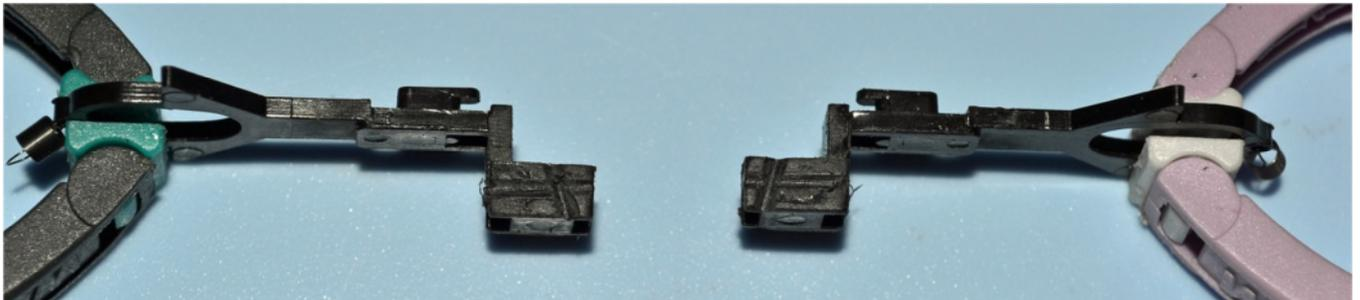
Auf beiden Seiten vom Normsacht mit einer runden Nadelfeile Rillen für die Verlegung der Kupplungslitzen feilen.
