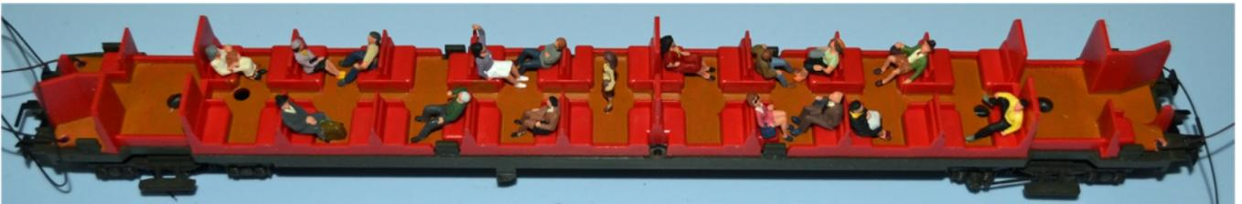
Die bestückten Kupplungsdeichseln wieder einsetzen und die Feder einhängen. Die Kupplungslitzen durch die Bohrungen ziehen und die Drehgestelle wieder einrasten. Inneneinrichtung mit H0-Figuren beleben und mit einem Sekundenkleber befestigen. Kontrollieren durch Gehäuse aufsetzen und einrasten. Ist alles i.O. Gehäuse wieder abnehmen.
