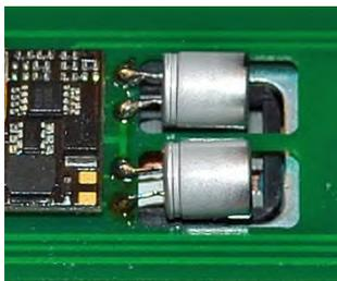
In meiner Bastelkiste waren noch mehrere SMD Aluminium Elektrolyte Kondensatoren / FK 220  $\mu$ F 16V vorhanden und wurden daher eingelötet. Es können natürlich auch andere 16V Kondensatoren beschafft werden die in die Platinen-Öffnungen passen. Die Lötpins in der Mitte sind +Pol, die aussenliegenden Lötpins sind Minuspol.
