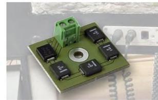
Den Widerstand an die Pins Schiene rechts (Pfeil **rot**) und Schiene links (Pfeil **schwarz**) anlöten.
