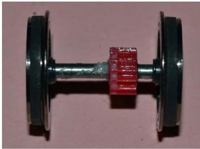
Am Schluss wurden die Radsätze mit Haftringen 124351 gegen Radsätze ohne Haftringen 124352 getauscht. Dies ist bei meiner H0-Anlage möglich, da keine extrem lange Zugkomposition gefahren wird und keine grosse Steigung vorhanden ist.
