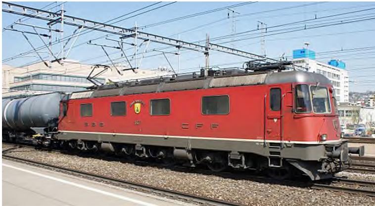
Die Re 6/6, nach neuem Bezeichnungsschema Re 620, sind sechsachsige, elektrische Lokomotiven der SBB, die als Ersatz für die Ae 6/6 im schweren Dienst am Gotthard angeschafft wurden. Aus den Anforderungen an die Baureihe ergab sich für die Traktion die Notwendigkeit von sechs Triebachsen. Um dennoch gute
