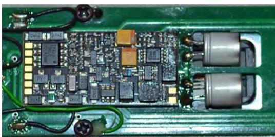
ZIMO MX645P22 Sounddecoder im Fachhandel beschaffen und in die Plux22 Schnittstelle einsetzen.
