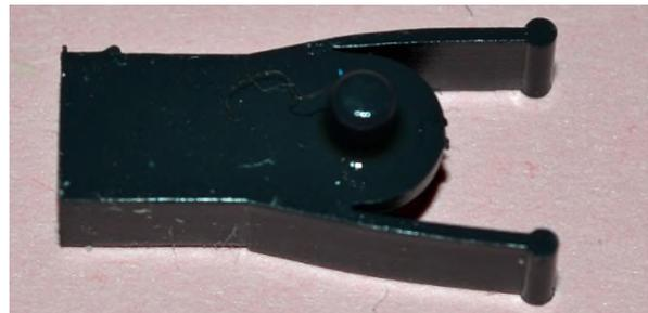
MK1-Universalkupplung in den Normschacht bis zur Rastung der Rastnasen einsetzen und die Litzen mit einem Sekundenkleber im Schlitz befestigen. Schwachstellen der MK1-Universalkupplung mit einem 2K-Klebstoff ummanteln und so sichern.
