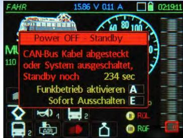
◀ Fahrpult im Kabelbetrieb, nach Abziehen des Kabels
