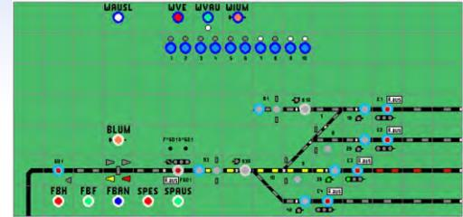
ESTWJ stellt die weitgehend vorbildgetreue Umsetzung von Spurplanstellwerken der Bundesbahnen in ein Modellstellwerk zur Steuerung digitaler Modellbahnen dar. Kernaufgabe des Programms sind die an der Sicherungstechnik des großen Vorbilds ausgerichteten Bedienungs- Überwachungs- und Auflösungsvorgänge beim Einstellen von Zug- und Rangierstraßen. ESTWJ setzt keinerlei Programmierkenntnisse voraus.
