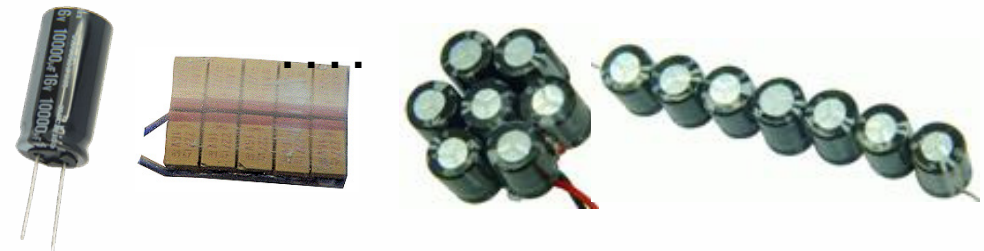
Elko Tantal-Paket 5000 µF Goldcap-Module mit 7 Goldcaps (7 x 1F in Serie, also 140000 F - 17,5 V)
