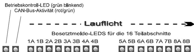
Das Laufflicht dient neben der Anzeige des Einschaltens auch als LED-Kontrolle. Wenn also eine einzelne LED nicht aufblinkt, ist diese LED defekt. Wenn nichts aufleuchtet (oder unkoordiniertes Flackern erscheint) ist der Modul selbst defekt.
