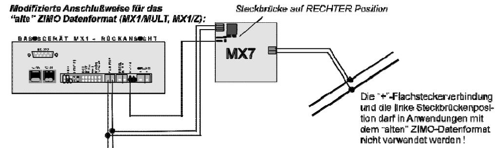
**Die Verwendung der Flachstecker und der Steckbrücke:**
