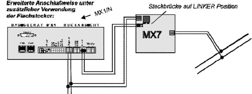
Modifizierte Anschlußweise für das "alte" ZIMO Datenformat (MX1/MULT, MX1/Z):
