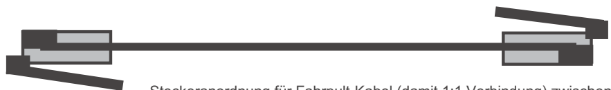
Steckeranordnung für Fahrpult-Kabel (damit 1:1 Verbindung) zwischen Basisgerät MX1 und Fahrpult MX2 bzw. von Fahrpult zu Fahrpult.
