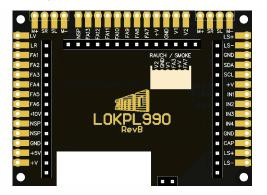
La platine (dans la révision B) porte une prise pour un fumigène ZIMO avec simple ou double ventilateur.
