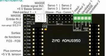
ELKO Plus / MASSE et SUSI1- ainsi que prise radio sur le *Decodeur*\*alt. SUSI1 Data(Servo3)/Clock (Servo4)
