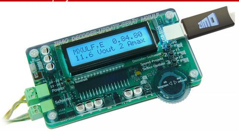
Brève description pour le chargement de nouvelles versions de logiciel (mise à jour) et de projets sonores dans les décodeurs MS et MN. Description complète, par ex. des procédures de mise à jour et de chargement pour plusieurs décodeurs en même temps ou de la conduite avec MXULF, voir le mode d'emploi du MXULF.
