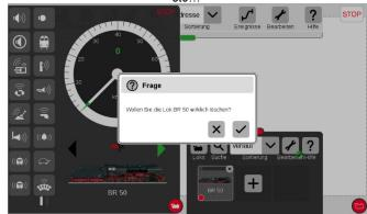
La locomotive à vapeur BR50 enregistrée dans le système doit maintenant être supprimée (plusieurs possibilités dans la CS 3). Après confirmation de la suppression, le décodeur est automatiquement réenregistré, désormais sous le nom de "BR 211".
