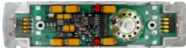
Lokplatte einer schwedischen „Class Du“ mit aufgestecktem Sound-Decoder MX644 (MTC-Schnittstelle). Integriert auf der Platine ist ein Energiespeicher (6 Tantals, gesamt 1300 µF)
