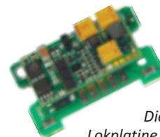
Die spezielle Lokplatine mit aufgestecktem MX648P16 für die „Berg“ Lok (BR 98)
