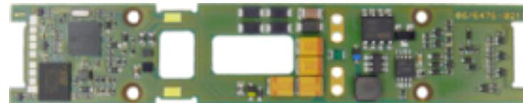
Beispiel: Lok-spezifischer Sound-Decoder für eine N-Spur Re 460
