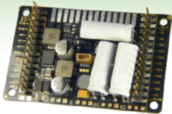
Die Stiftleisten der Großbahn-Decoder sind in Standardausführung (MX699LS und MX699LV) 6 mm lang über Sockel (d.h. 10 mm über Platine); Sonderausführungen: MX699LLS und MX699LLV mit 12 mm langen Stiftleisten über Sockel (16 mm über Platine)
