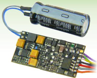
Energiespeicher werden am Decoder angeschlossen ...
