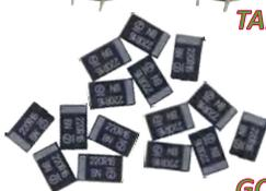
Tantal - Sortiment (30x 220 µF, o.ä.) für 2 bis 4 ZIMO Decoder (10 bis 20 pro Decoder) mit direktem Energie-Speicher-Anschluss „16 V“
