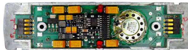
Lokplatine einer schwedischen „Class Du“ mit aufgestecktem Sound-Decoder MX644 (MTC-Schnittstelle). Integriert auf der Platine ist ein Energiespeicher aus 6 Tantals (gesamt 1300 µF).
