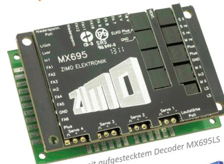
Lok-Platine mit aufgestecktem Decoder MX695LS
