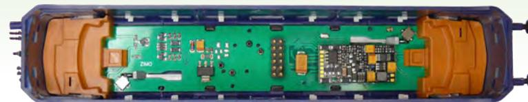
Lokplatine der E10 in H0, eingebaut im Modell, mit Ansteuerung für die Mikro-Motoren der Panto-Antriebe und deren Endabschalter; Federkontaktleiste zur Dachplatine der Lok und 22-polige Buchsenleiste mit aufgestecktem Decoder MX645P22.
