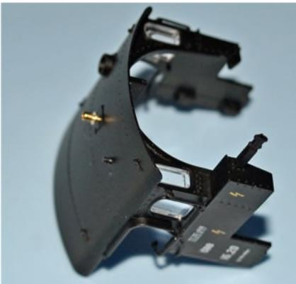
Mit einem Flachschaubendreher 2 von 3 Steuerstangenhalterungen aushebeln. Richtungswechselstange vom Führerhaus lösen. Teile in den TS-Steuerstangen 109296. Kesselrückwand mit Armaturen 110249 vom Kessel kpl. lösen und das Führerhaus kpl. 140391 nach oben ausrasten.
