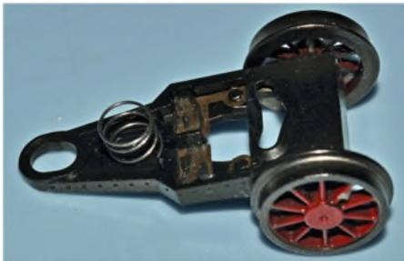
Laufgestellsatz 110248 samt Vorlaufradsatz 110452 und Laufgestelldruckfeder 115176 abziehen und aufbewahren.
