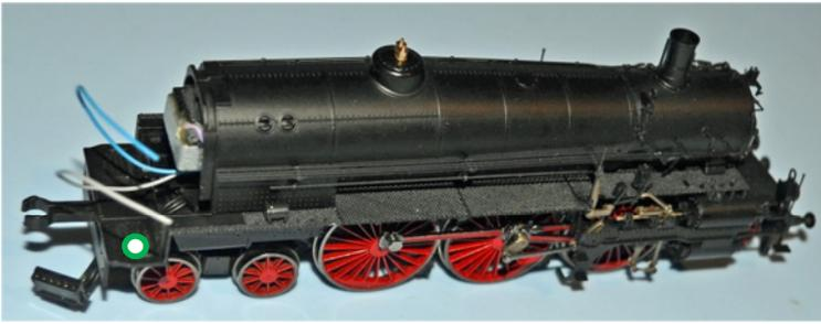
Standfläche **O**, im Steckteilesatz 109239, über die Lok-Tender-Kupplung 109546 ziehen und die Zapfen einstecken.
