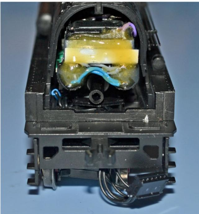
Beide Kondensatoren mit einer doppelseitig klebenden Klebefolie am Gewicht befestigen. Eine parallele Verbindung beider Kondensatoren löten.
