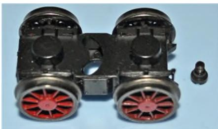
Nachlaufgestell komplett einsetzen und mit der Ansatzschraube 109252 befestigen.
