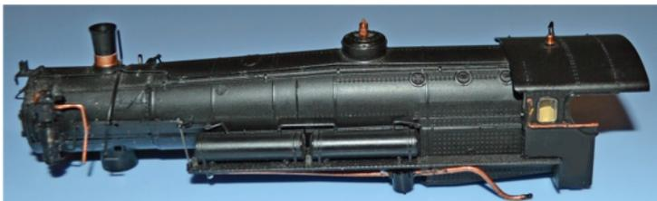
Kessel kpl. 140387 nach oben abnehmen. Dazu muss man einige Kesselsteckteile lösen, welche dies sind merkt man schnell, da der Kessel kpl. an diesen hängen bleibt.
