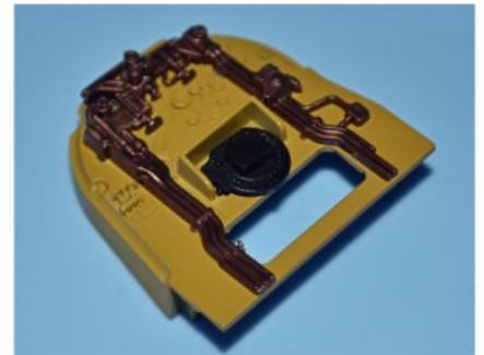
Kardanschale lang 109248 abziehen, Deckplatte  $\Delta$  der Steckverbindung 109272 von den Zapfen lösen, Steckverbindung herausziehen, die Zapfen der Standfläche  $\circ$  nach oben lösen und über die Lok-Tender-Kupplung 109546 rausziehen. Teile ohne Nummer im TS-Steckteilesatz 109239.
