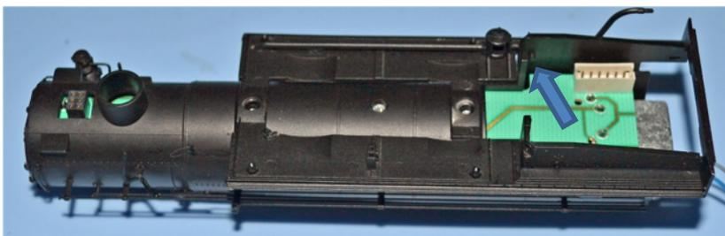
Umlaufblech 115178 auflegen und mit den 2 GF-Schrauben M1.6x6 mm befestigen.
