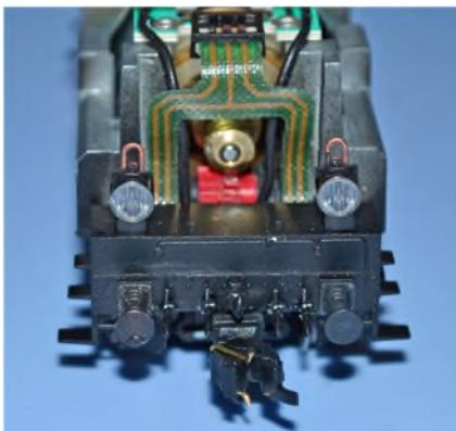
Pufferbohle (TS-Tender 109256) vorsichtig nach oben abziehen, Flexplatine Tender 109260 herausziehen und ablegen. 2 Bohrungen  $\text{\O} 1.3 \text{ mm}$  durch Tendergrundrahmen 109292 und Kupplungsplatte 109547 (11) bohren. Die stromführende Kupplung einsetzen und die Litzen durch die  $\text{\O} 1.3 \text{ mm}$  Bohrungen nach oben ziehen.
