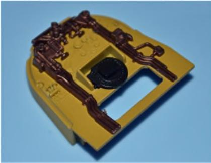
Zuerst muss die von Roco falsch montierte Kesseltür um 180° versetzt werden.
