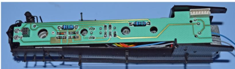
Litzen für den Anschluss eines Speicherkondensators nach hinten ziehen. Die Schnittstellenlitzen sorgfältig einlegen und die Kesselplatte auflegen.
