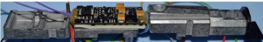
ZIMO MX645R Sounddecoder mit einem doppelseitig klebenden Montageband in die vorgesehene Freistellung befestigen. Litzen sauber verlegen und die Litzenlötlungen mit einem 2K-Klebstoff wegen Kurzschlussgefahr (Kontakt mit dem Metallguss) und Loslösung sichern.
