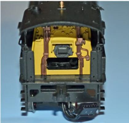
Dazu muss man mit einem Flachsraubendreher 2 von 3 Steuerstangenhalterungen aushebeln.
