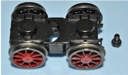
Ansatzschraube 109252 lösen und ausdrehen. Nachlaufgestell komplett abnehmen und aufbewahren.
