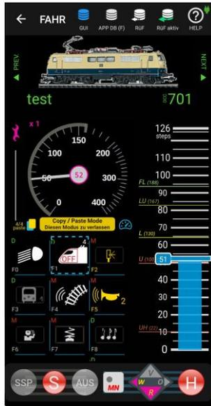
Fahrzeuginformation und Funktionssymbole, also ein Teil der GUI-Elemente für ein Fahrzeug (für eine Adresse), werden auf verschiedene Art, aus verschiedenen Quellen zugeordnet (je nach Situation, Fähigkeiten von Bediengeräten und Decodern):
