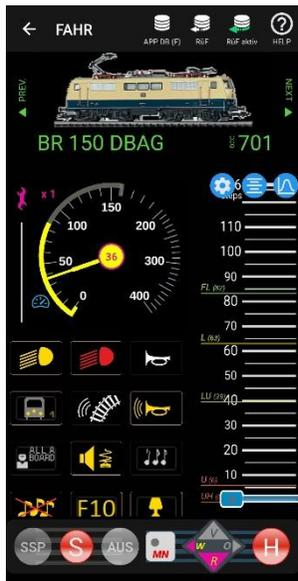
Dies ist der Bildschirm zum Steuern einer Lok (zukünftig auch für Traktionen und Züge); aufrufbar vom Bildschirm APP DB (F) oder RUF durch Touch auf eine Zeile (im Bereich Name, Adresse), oder auch durch Nutzung der von „PREV“ or „NEXT“ am FAHR-Bildschirm eines anderen Fahrzeugs. Die **grundsätzliche Anordnung** ist **ähnlich** den **Fahrpulten MX32/MX33**.
