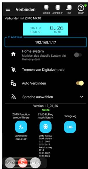
Zur WLAN-Verbindung mit dem Basisgerät MX10 muss dieses über LAN mit einem Router oder mit einem Home Network verbunden sein. Nach dem Start der ZIMO APP und Öffnung des Start-Bildschirms "Verbinden" wird die IP Adresse des Basisgerätes eingetippt. Diese findet man im MX10 Menü unter "PC Config+Monitor" und dort "LAN IP" (wo sie natürlich auch geändert werden kann).
