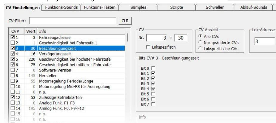
Durch **Klick auf die zu ändernde CV** in der linken Liste werden im rechten Bereich die **zugehörigen Einstellungsmöglichkeiten** angezeigt. Die benötigte CV kann alternativ durch scrollen oder über den **CV-Filter** gesucht oder direkt im Feld „**CV Nr.**“ eingegeben werden.
