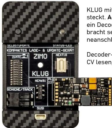
KLUG mit Decoder direkt angesteckt. **Achtung:** es soll immer nur ein Decoder direkt am KLUG angebracht sein, weitere über Schiebeanschluss oder SUSI Buchse.
