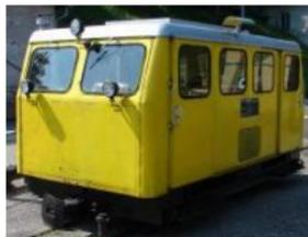
Es handelt sich hier um eine Dieselmehrantriebs Lok. Derartige Motordraisinen findet man sowohl bei der Schmalspur, als auch bei Regelspur! Das 4 Tonnen schwere Fahrzeug erreicht in der 'Schmalspur-ausführung' eine VMax von 40Km/h.
