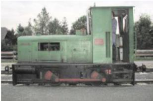
Es handelt sich hier um eine Dieselmehrantriebs Lok. Bis Ende der Siebziger Jahre wurde sie als Werkslokomotive der Blei- und Silberhütte Braubach (an der Nassauischen Kleinbahn gelegen) eingesetzt. Nach Aufgabe des Schmalspurbetriebs bei Braubach kam die Lokomotive 1980 als Geschenk der BRD-Regionalvertretung zum Club 760. Im Winter 1987/88 wurde sie von 750 auf 760 mm umgespurt. 1988 wurde die Lok dann nach Mauterndorf überstellt, wo sie für Arbeitszüge und als Reservelok eingesetzt wird.
