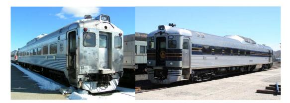
Das Budd Rail Diesel Car (Budd RDC) ist ein dieselhydraulisch angetriebener Triebwagen, der von der Budd Company zwischen 1949 und 1962 für den Einsatz auf schwach genutzten Personenverkehrsverbindungen gebaut wurde.
