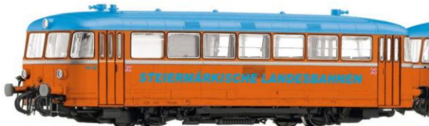
Uerdinger Schienenbus ist die umgangssprachliche Bezeichnung von Schienenbussen, die von der Waggonfabrik Uerdingen entwickelt wurden. Es handelt sich um dieselbetriebene, zweiachsige Triebwagen in Leichtbauweise mit unter dem Wagen im Fahrgestell eingebauten Dieselmotoren.
