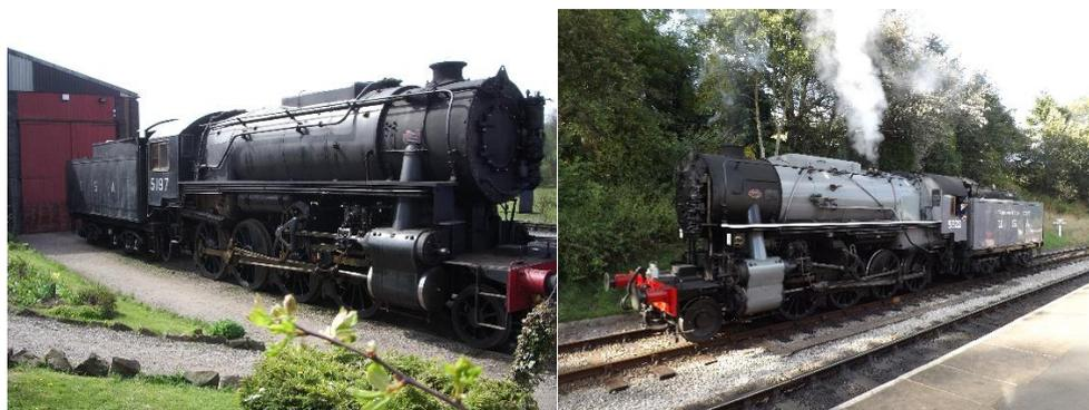
Die USATC Klasse S 160 waren Kriegslokomotiven des United States Army Transportation Corps USATC. Diese Lokomotiven mussten weltweit einsetzbar sein und hatten daher englisches Lichtraumprofil, das für Vollspurbahnen eines der kleinsten ist. Insgesamt wurden 2120 Stück von Baldwin, ALCO und LIMA gefertigt, womit diese Klasse zu den meistgebauten Lokomotiven der Welt gehört. Die meisten Maschinen waren kohlegefeuert, einige der zuletzt gebauten ölgefeuert.
