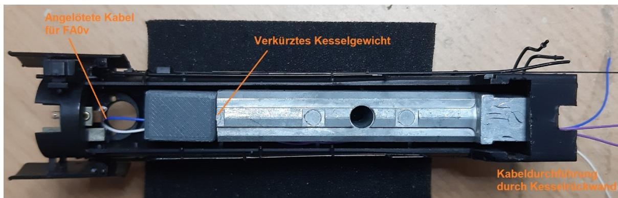
Hier wird ein LS13x18 in den Kessel eingebaut, dabei wird der Aufbau für den Rauchgenerator am Rahmen sowie das Kesselgewicht gekürzt. Die Platine des vorderen Spitzenlichts erhält einen neuen Anschluss mittels angelöteter Kabel.
