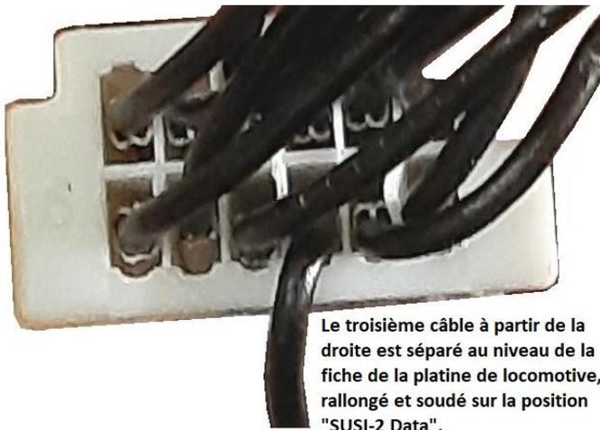
Le troisième câble à partir de la droite est séparé au niveau de la fiche de la platine de locomotive, rallongé et soudé sur la position "SUSI-2 Data".
