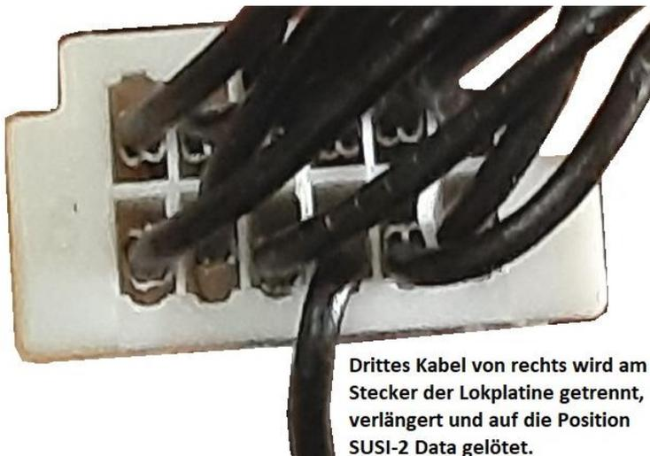
**Drittes Kabel von rechts wird am Stecker der Lokplatine getrennt, verlängert und auf die Position SUSI-2 Data gelötet.**
