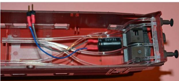
An den Speicherkondensator die Anschluss-Litzen löten, **blau** = +Pol, **grau** = -Pol. An die Litzen einen 2-Pol-Abschnitt von einer Stiftleiste anlöten. Lötungen mit einem Schrumpfschlauch sichern. Speicherkondensator mit einem Sekundenklebstoff im Freiraum zwischen den Lichtleitern befestigen.
