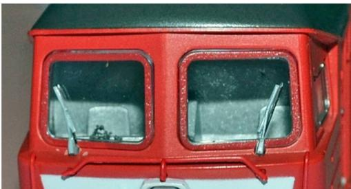
Beidseitig genau unterhalb der angespritzten Scheibenwischer, schräg nach unten eine Ø 1.0 mm Bohrung fertigen. Die Spritzlinge aus dem Scheibenwischersatz 115358 schneiden und mit ganz wenig Sekundenkleber am Befestigungszapfen in die Bohrung einsetzen, ausrichten und Klebstoff abbinden lassen.
