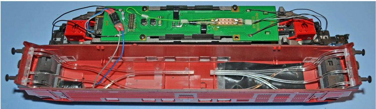
Steckverbindung herstellen, Schrumpfschlauch am Stecker nur sichern, nicht an der Platine festkleben. Gehäuse kpl. Betriebs-Nr.: 232 536-3 aufsetzen und einrasten.
