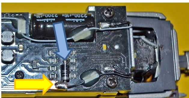
Aus einer Streifenplatine 2 kleine 1-Streifen-Löt pads fertigen und mit einem Sekundenklebstoff auf der Platine kpl. für Sound 142424 befestigen. Eine 1N4004 Diode in Richtung +Pol an den Widerstand (Pfeil **blau**) löten. Wurde mit einem Multimeter von PIN 9 der Schnittstelle ausgepiepzt und ist volle Schienenspannung. Mit der schwarzen +Pol Litze der Telexkupplung verbinden, löten (Pfeil **gelb**).
