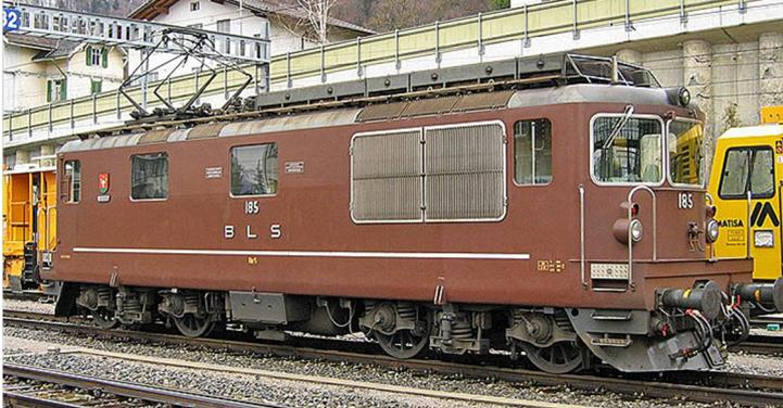
Aufgrund der sehr erfolgreichen Konstruktion der Ae 4/4 der BLS, der ersten laufachslosen Hochleistungslokomotive der Welt, leiteten die BLS und SLM die Neuentwicklung von dieser Reihe ab. Das ist auch an der Kastenform eindeutig zu erkennen, die Anordnung der Einstiege an der Lokfront wurde von der Ae 4/4 übernommen. Das Fahrgestell ist ähnlich demjenigen der SBB Re 4/4 II. Doch schon da hören die Gemeinsamkeiten zu dieser auch sehr
