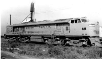
Die zweite Bauserie mit den Lokomotiven 61 bis 75 wurde ab 1954 ausgeliefert. Diese Lokomotiven unterschieden sich äußerlich deutlich von denen der ersten Bauserie. Überdachte, seitlich offene Wartungsgänge auf beiden Seiten brachten ihnen den Spitznamen "Verandas" ein. Die Turbine erzeugte eine Leistung von 4800 PS. Das war mehr als die doppelte Leistung damaliger dieselektrischer Lokomotiven.
