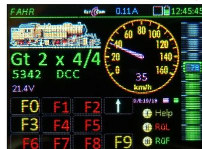
Nach ca. 0,2 sec (bei ungestörter Übertragung) sind bereits die Informationen für Bild, gewählte Tachoscheibe und Name eingetroffen; Funktionssymbole fehlen noch.
