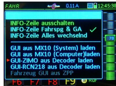
**A-Taste** → Die GUI-Übermittlung läuft nun **SICHTBAR** für den Anwender ab, d.h. es kann das Eintreffen der verschiedenen GUI-Elemente (Lokbild, Name, Tacho, Funktionssymbole, ...) mitverfolgt werden (auf Wunsch auch Abbrechen möglich). Auch eventuelle Übertragungsstörungen sind dabei zu erkennen: leer bleibende Symbole, und spätere automatische Nachlieferung.
