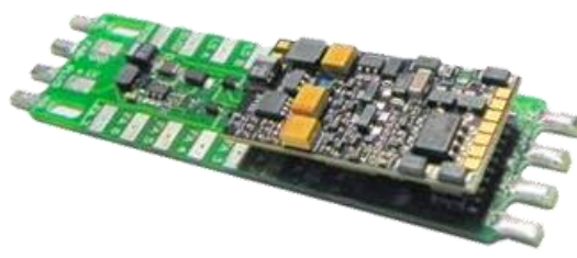
ADAPUS mit Sound-Decoder MX645P22 , 71 x 18 x 8 mm (als Austausch-Decoder für US-Modelle)
