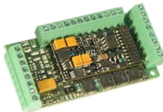
ADAMKL (mit Schraubklemmen) mit Sound-Decoder MX644C
