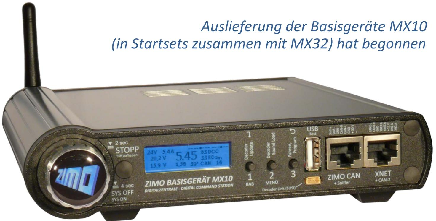
Das neue ZIMO System besteht aus dem **Basisgerät MX10** (standardmäßig mit dem MiWi Funk-Modul ausgerüstet, daher nur eine Variante), den Fahrpulten **MX32** und **MX32FU** (ohne bzw. mit Funk), und ab etwa dem 2. Quartal 2015 auch aus den **StEin-Modulen**.
