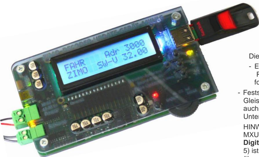
MXULF - oder besser die Variante MXULFA, also jenes mit Display - das Decoderupdate- und Soundlade-Gerät, ist ab Softwareversion 0.22 auch für den autonomen Fahrbetrieb (d.h. mit eigenen Bedienungselementen, ohne Computer) geeignet; ab 0.32 ist auch das Soundladen über SUSI aktiv.
