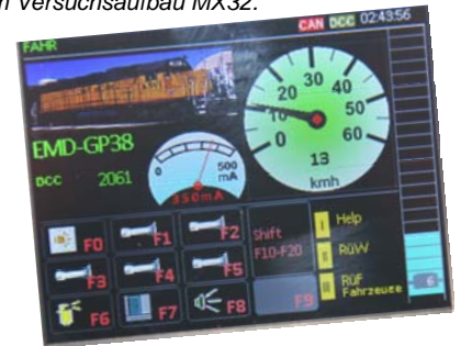
Bild: MX32 Anzeige-Entwicklungsversion im FAHR - Zustand am Versuchsaufbau MX32.
