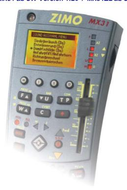
ZIMO Sound Decoder werden vorzugsweise mit einer "Sound Collection" ausgeliefert. Dies ist Spezialität des ZIMO Sound Konzepts wird durch den großzügig bemessenen Speicherplatz im Decoder ermöglicht: Sound-Samples und Parameter für mehrere Fahrzeugtypen (beispielsweise 5) sind gleichzeitig im Decoder gespeichert; durch Auswahl-Prozeduren wird vom Fahrgerät her bestimmt , welche Geräusch-Kombination tatsächlich im Betrieb erklingen soll.
