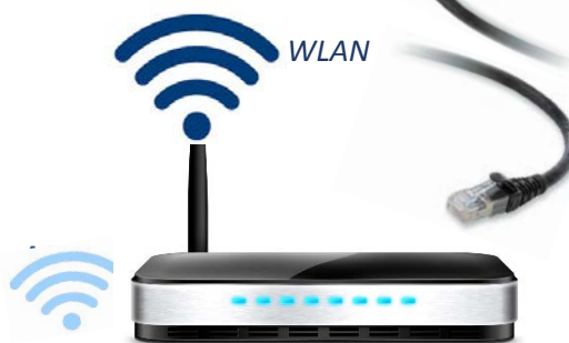
Router, vorzugsweise Produkt mit IP-Adresse 192.168.1.xx; diese ist im MX10 bereits voreingestellt – keine Konfiguration notwendig (aber möglich).
